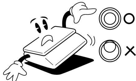
Nevystavujte váhu intenzivnímu proudění vzduchu (například z ventilátora) ani vibracím – znemožňuje to ustálení váhy a tím dochází i ke snížení přesnosti.
