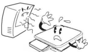
Váhu nevystavujte intenzivnímu proudění vzduchu (např. z ventilátoru) – znemožňuje to ustálení váhy a tím dochází ke snížení přesnosti.
