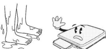
Váha není určena do mokrého nebo chemicky agresivního prostředí. Krytí proti vodě a prachu je pouze třídy IP-54. Nedoporučuje se také používat agresivní prostředky pro čištění indikátoru z důvodu možného poškození klávesnice.
