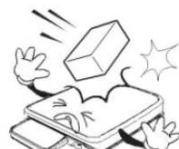
Váhu nevystavujte mechanickým rázům – mohlo by dojít k poškození tenzometrického snímače zatížení nebo elektroniky. Mějme na paměti, že váha je měřidlo a podle toho je třeba s ní zacházet.
